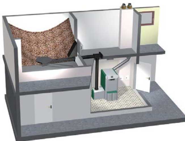
Almacén de combustible y sala de calderas a distintos niveles. Descarga horizontal mediante agitador rotativo y tubo de caída.
