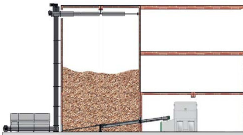
Almacén de combustible situado al lado de la sala de calderas.
