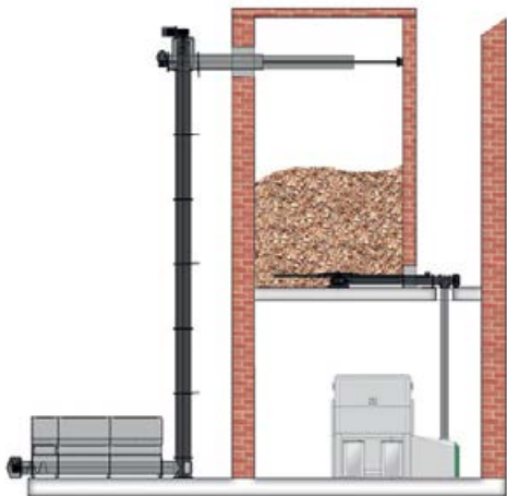
Almacén de combustible ubicado encima de la sala de calderas.
